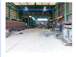
木造は削り、RCは固め、鉄骨はくっつける。構造により部材の作り方も変わるのは面白いですね。今回はその中の鉄骨です。ものすごく簡単に言えば、鉄を切って溶接でくっつける作業ですが、実際にはすみ肉の厚さが許容値内か、余盛りが大きすぎないか、ビートが綺麗に出ているかなど、技術も管理も難しく超繊細な作業を着々と行なっています。
